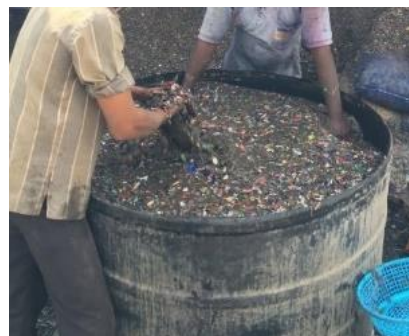
Ndarja e copezave plastike nepermjet fundosjes/pluskimit
