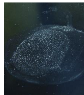
Depozitime te bardha si pasoje e reagimit te acetoneit me PC
